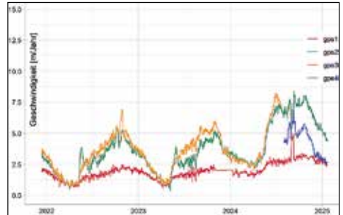
Bewegungen 2022 - 2025 der drei GPS. Im Juli 2024 wurde das GPS 3 an einen neuen Standort versetzt und die Datenreihe wird seither als GPS4 bezeichnet. Die gemessenen Geschwindigkeiten waren im Sommer 2025 ähnlich zum Sommer 2024 deutlich höher als in den Vorjahren.
